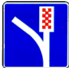
6.5 Полоса для аварийной остановки
