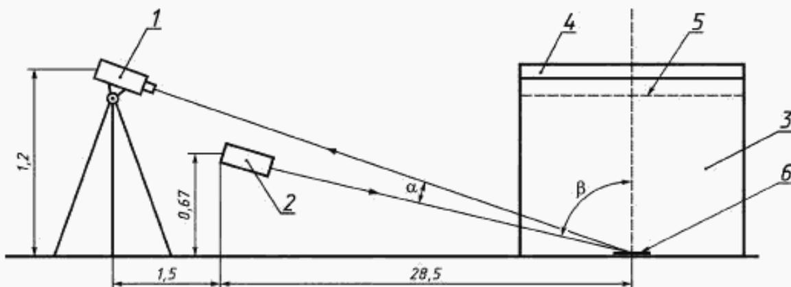
1 — аркомер; 2 — источник света; 3 — дождевальная установка; 4 — шланг; 5 — сетка; 6 — дорожная разметка
