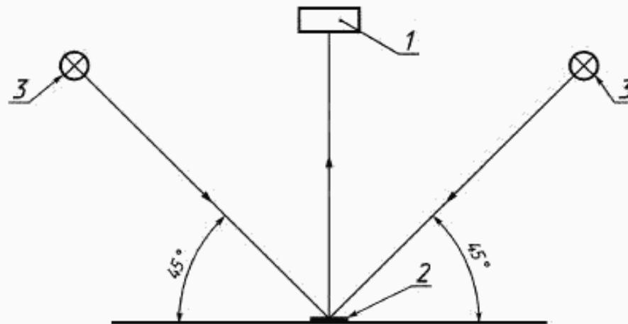
1 — спектрофотометр или колориметр; 2 — дорожная разметка; 3 — источник света
