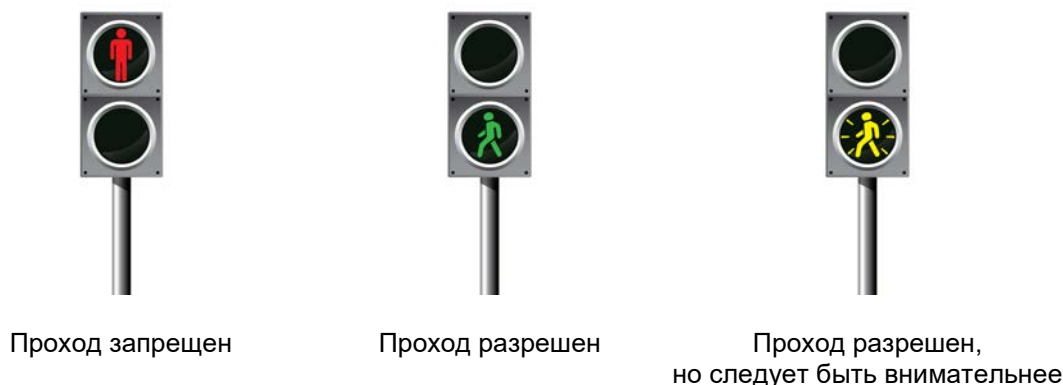
Рисунок 41 – Пример работы пешеходного светофора
