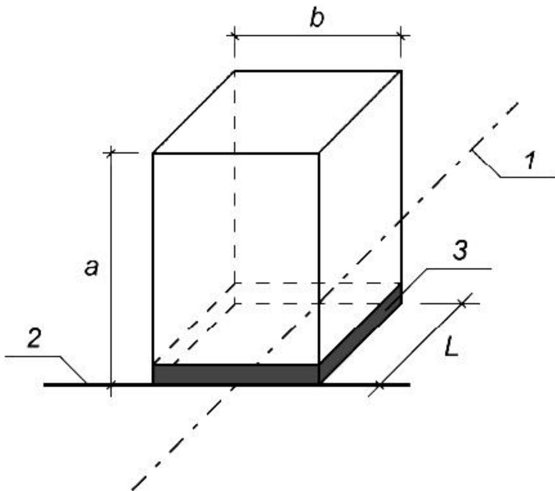
$a$  - высота тумбы,  $b$  - ширина тумбы,  $L$  - длина тумбы; 1 - ось тумбы, параллельная направлению движения транспортных средств; 2 - плоскость установки; 3 - основание тумбы
