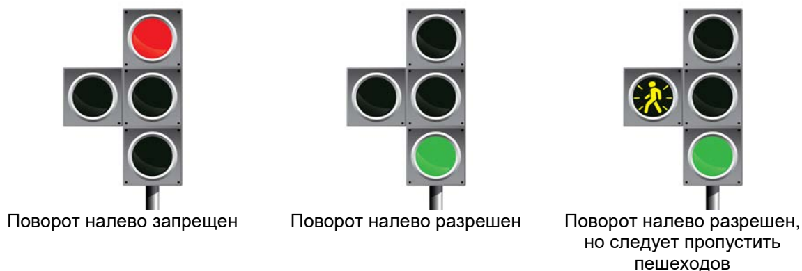
Рисунок 43 – Вариант расположения дополнительной секции с изображением мигающего пешехода на светофорах без лево- и правоповоротных секций
