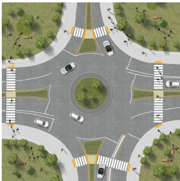
Рисунок 54 – Компактные двухполосные кольцевые перекрестки
