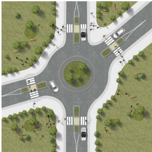
Рисунок 53 – Компактные однополосные кольцевые перекрестки
